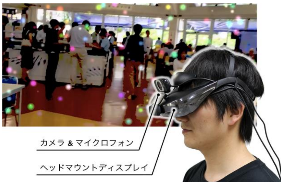
図 1: ASD 知覚体験シミュレータ。カメラとマイクロフォンから入力された視聴覚信号を実時間で処理し、ヘッドマウントディスプレイ上に ASD の視覚世界を再現します。本シミュレータを用いることで、ASD の特異な知覚が社会的行動に与える影響や、脳活動に与える影響を調べることが可能に
