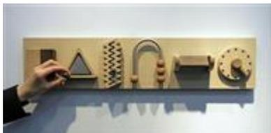
三菱電機などが試作したリモコンパネル（左から）電源、運転モード、温度、風量、風向き、タイマー
